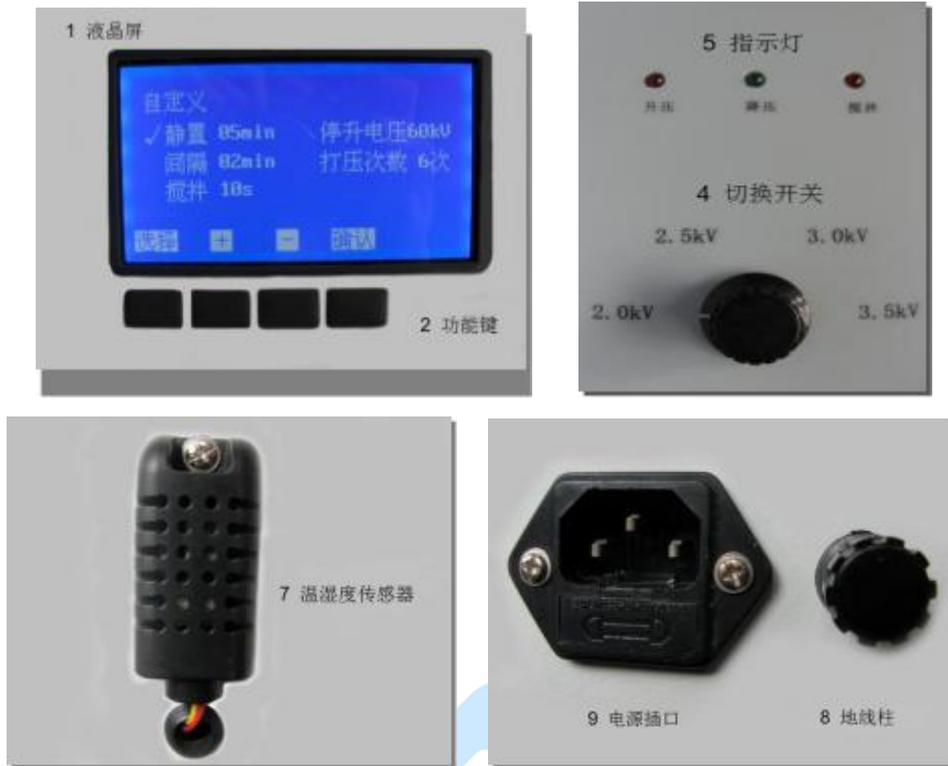
① 液晶屏：显示日期、时间、操作参数、测试结果、操作菜单提示等相关信息；
