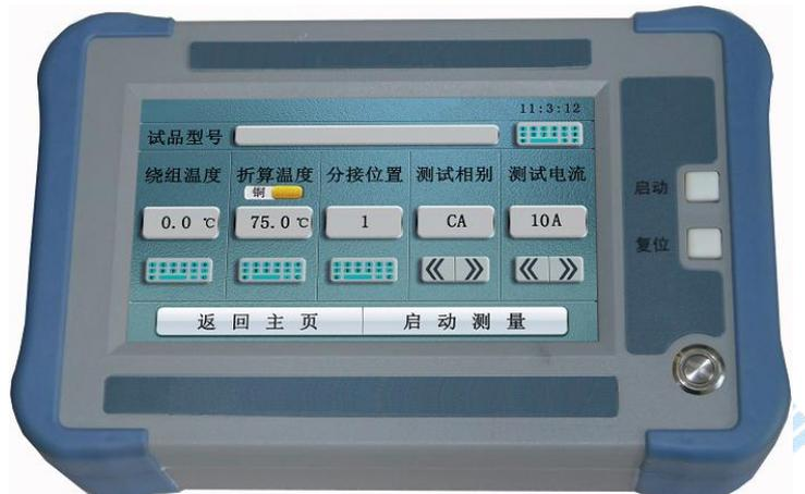
1. 液晶屏：显示操作提示及测试数据
